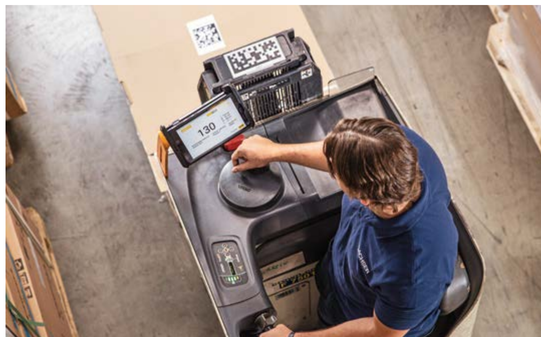
Technologie @ILO (Advanced Indoor Localization and Operations) na principu digitálního dvojčete v tranzitním terminálu společnosti Dachser. Základní technologií jsou zde optické snímací jednotky. Odpadá ruční skenování čárových kódů a dodatečné označování zásilek.
