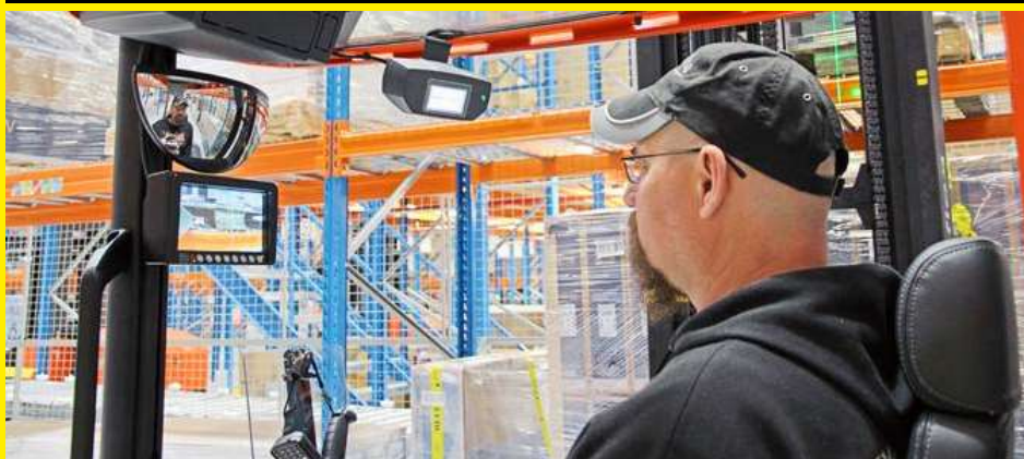
Nové vozíky RRE140H budou vybaveny kamerou na vidlicích. Kamera zajistí přehled o pozici vidlic pro zasunutí do palety.
