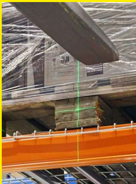
Laserové ukazovátka pomáhá obsluze zaujmout správnou polohu u regálu. Pokud zhasne, indikuje špatný náklon vidlic a obsluha musí vidlice srovnat do vodorovné polohy.
